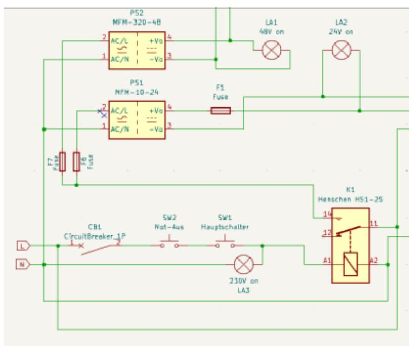
Als Eingangssicherung dient ein Überbleibsel ABB D6, danach wird gesplittet.
