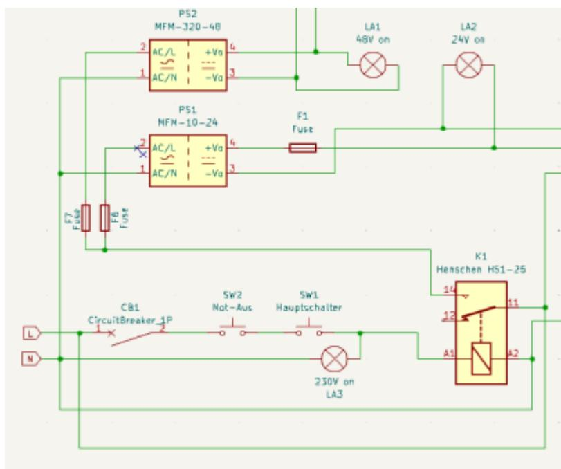
Als Eingangssicherung dient ein Überbleibsel ABB D6, danach wird gesplittet.
